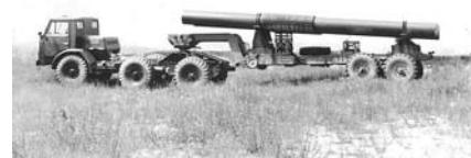
Седельный тягач ЗИЛ-132РС с полуприцепом ЗИЛ-137Б, на котором установлен массово-габаритный макет перевозимых ракет
