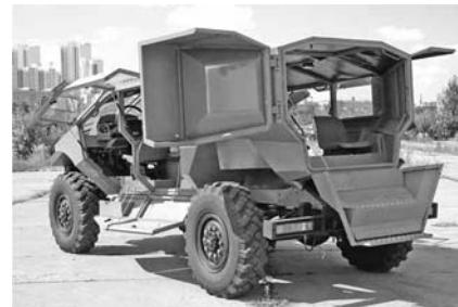
Все двери машины сделаны так, чтобы они открывали максимальный проём и не мешали быстро покинуть машину бойцами силовых структур
