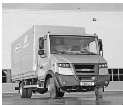
Модернизированный автомобиль ЗИЛ-4362 с новой каркасно-панельной кабиной
