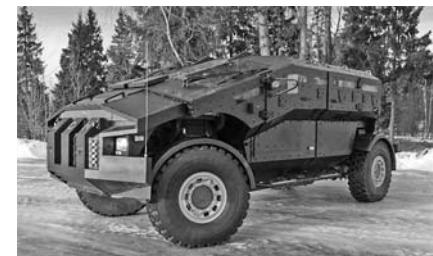
Прототип автомобиля Falcatus, изготовленный АО «ФОРТ Технология» в интересах ЦСН ФСБ России, на шасси другого автопроизводителя
