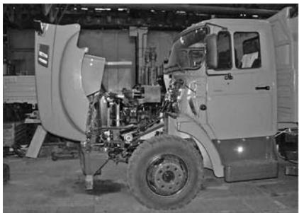
Новое оперение сделано интегральным — откидывающимся вперед вместе с крыльями автомобиля и предоставляющим свободный доступ ко всем системам силового агрегата автомобиля.
