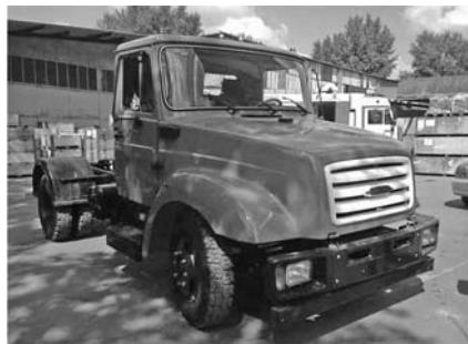
Опытный образец автомобиля ЗИЛ-432940 с новым оперением
