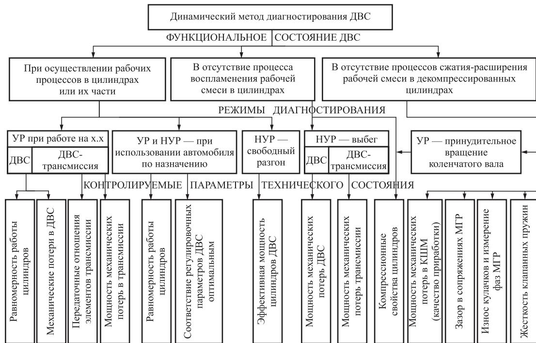
Рис. 2. Классификация режимных признаков и контролируемых параметров элементов ДВС при динамическом методе диагностирования
