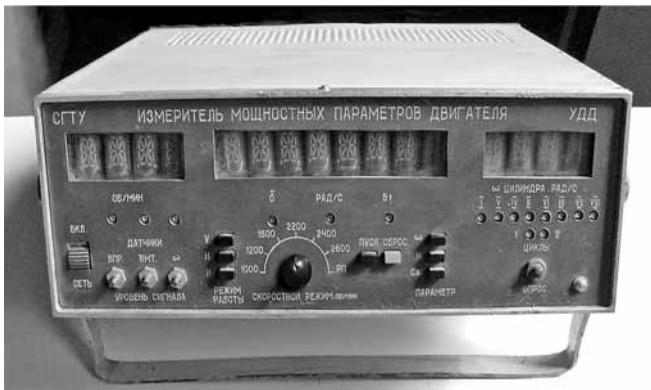
**Рис. 4. Внешний вид устройства для поэлементного диагностирования ДВС динамическими методами**
