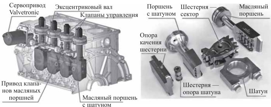
Рис. 9. Механизм регулирования двигателя типа МСЕ-5 с переменной степенью сжатия (а) и его основные детали (б)
