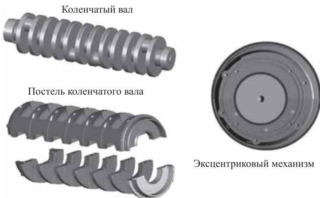
Рис. 14. Коленчатый вал и эксцентриковый механизм VCR-двигателя фирмы Caterpillar
