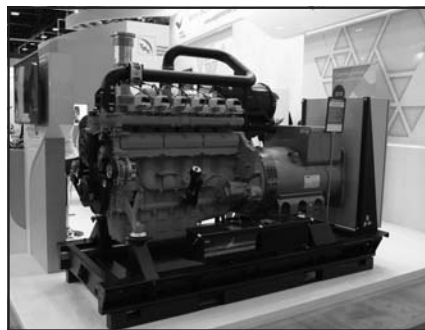
Газопоршневая установка "Компании Дизель"
