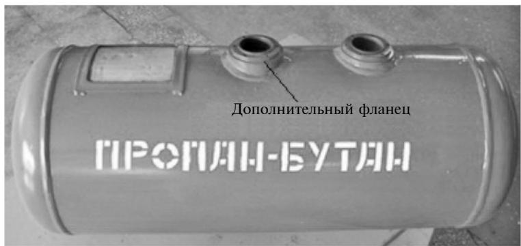
Рис. 1. Общий вид автомобильного газового баллона с установленным дополнительным фланцем
