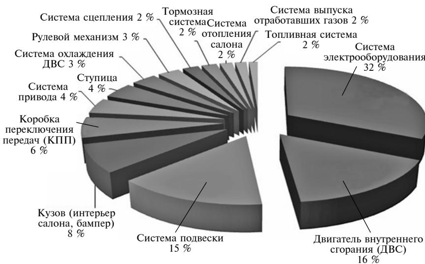
Рис. 1. Диаграмма распределения основных систем автомобиля по уровню дефектности за 2015 г.
