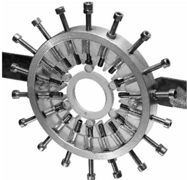
Рис. 4. Интегральный патрон с кольцом и дисковыми оптическими динамометрами на ППУ-7
