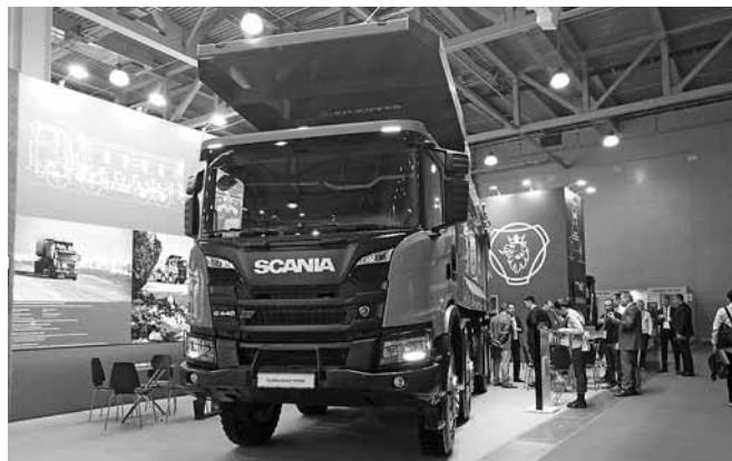
На стенде компании "Scania-Русь" был представлен абсолютно новый продукт в России: самосвал Scania Heavy Tipper G440 B8x4HZ с кузовом для перевозки скальных пород объемом 25 м<sup>3</sup> в совокупности с полным спектром дополнительных услуг: широким портфолио контрактных сервисов, предложениями по контролю автопарка, услугами лизинга.
