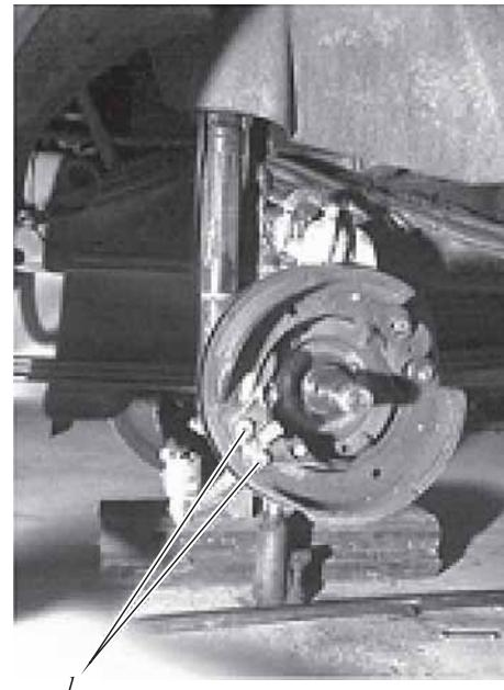
Рис. 5. Поворотные оси колодок барабанного тормоза автомобиля МАЗ-544018-320-030, включающие датчиками измерения тормозного момента (силы) в контакте колес с опорной поверхностью:
