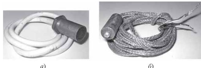
Рис. 3. Индукционные датчики измерения реализуемых колесами тормозных моментов и их производных по времени:
