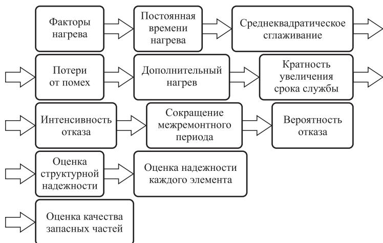
**Рис. 1. Схема последовательности факторов, влияющих на отказ ЭО**
