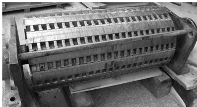
Рис. 5. Ножевой вал (реновируемый наплавкой) стружечного станка мод. ДС-8
