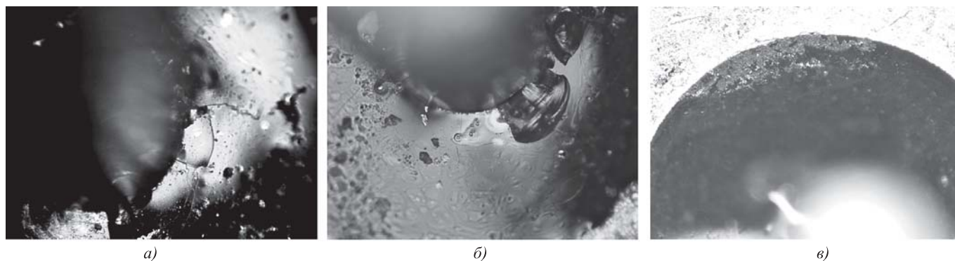
Рис. 2. Металлостеклянные спаи с дефектами: трещинами (а); сколами по внутреннему диаметру стеклотаблетки (б); нарушением структуры стекла по внешнему диаметру стеклотаблетки (в)
