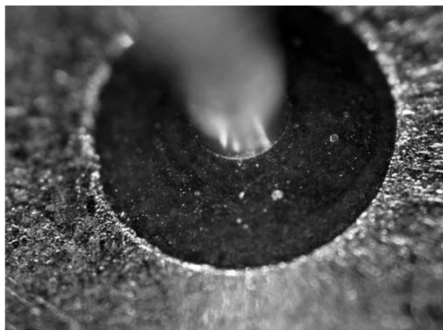
Рис. 1. Металlostеклянный спай без дефектов
