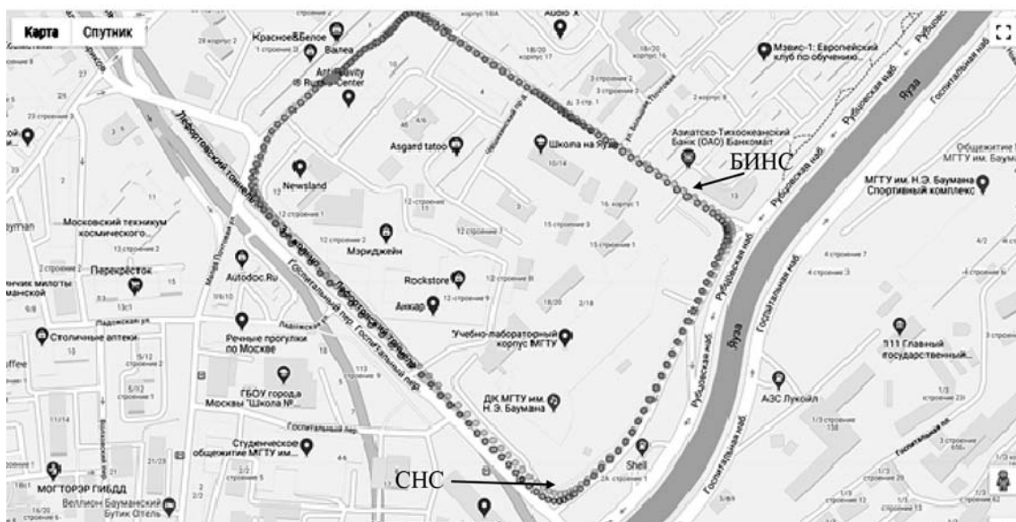
Рис. 4. Погрешность БИНС с коррекцией от СНС с ФК в случае присутствия в измерениях 15 % аномальных выбросов 1,53 м
