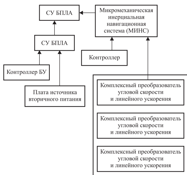
Блок-схема полунатурного стенда:
