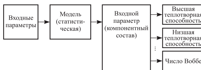
Рис. 2. Схема корреляционного метода определения энергетических характеристик по компонентному составу
