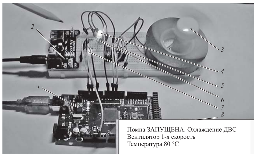
Рис. 5. Контроллер MEGA 2050 (а) и блок питания (б)
