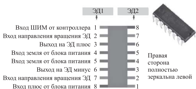
Рис. 4. Драйвер двигателя
