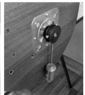
Рис. 4. Мотор-маятник (вид спереди)
