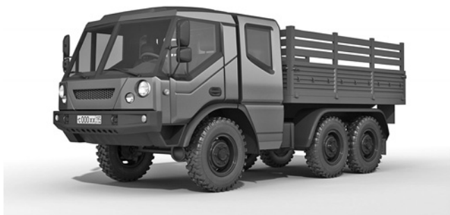
Рис. 3. Эскиз автомобиля из семейства "Дивизион" с укороченной грузовой платформой и кабиной с дополнительной однорядной секцией на 3 пассажирских места
