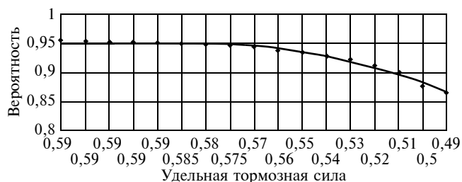
Рис. 6. Зависимость вероятности безотказной работы тормозной системы от удельной тормозной силы на наработке от 57,5 до 77,5 тыс. км
