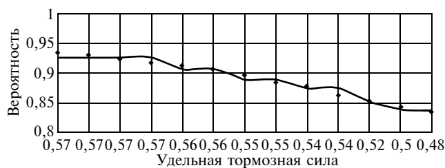
Рис. 5. Зависимость вероятности безотказной работы тормозной системы от удельной тормозной силы на наработке от 47,5 до 55 тыс. км
