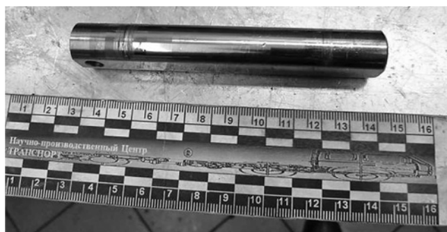
Рис. 7. Повреждения оси сателлитов
