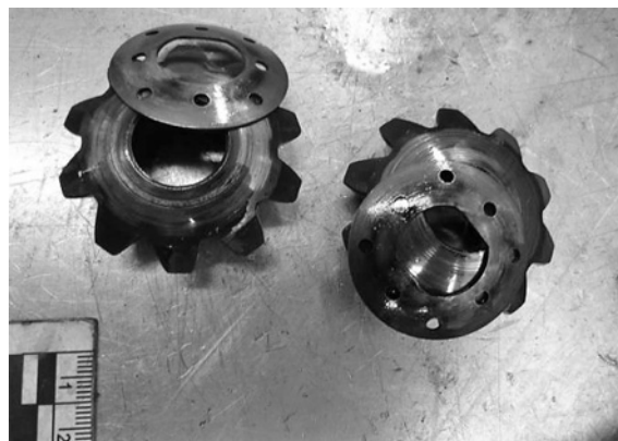
Рис. 9. Повреждения на сателлитах в местах прижатия их к коробке дифференциала
