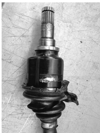
Рис. 6. Разорванный защитный чехол внутреннего шарнира правого вала
