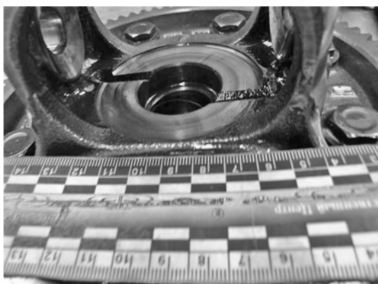
Рис. 11. Посадочная поверхность полуосевой шестерни в корпусе дифференциала
