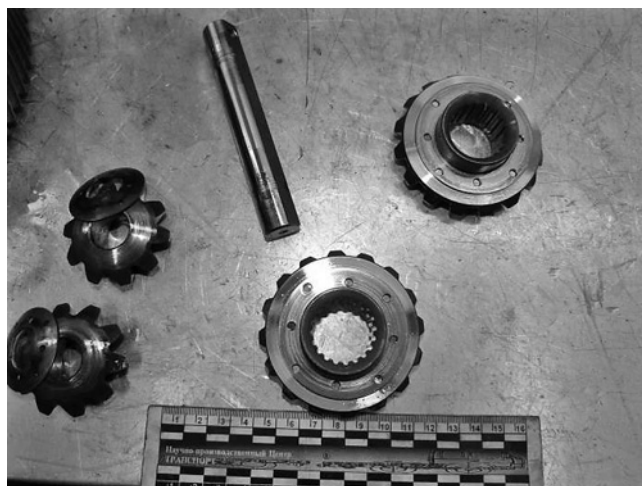
Рис. 8. Полуосевые шестерни и ось, сателлиты с шайбами
