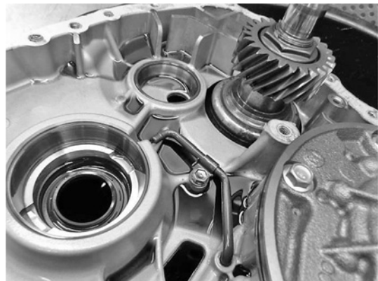
Рис. 3. Отсутствие посторонних включений в технологических отверстиях
