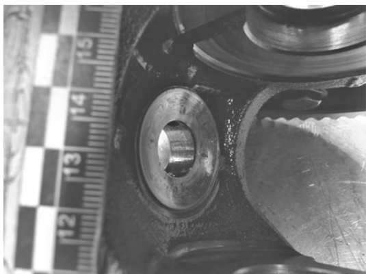
Рис. 10. Посадочная поверхность сателлита в корпусе дифференциала
