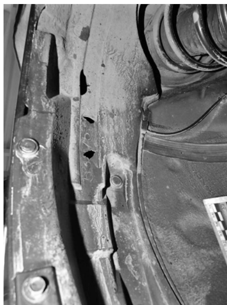
Рис. 13. Повреждения подкрылка правого переднего колеса
