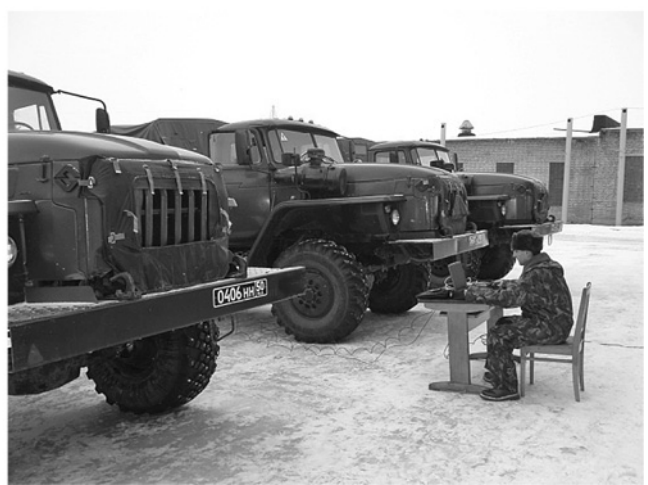
Рис. 2. Проведение натурных испытаний систем электростартерного пуска с суперконденсатором на специальной автомобильной технике
