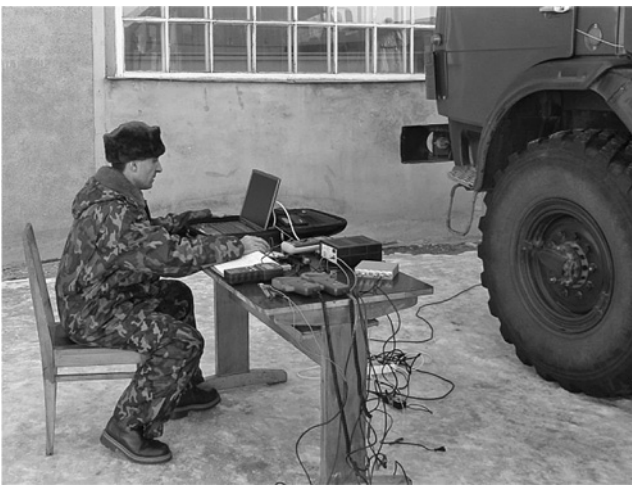
Рис. 2. Проведение натурных испытаний систем электростартерного пуска с суперконденсатором на специальной автомобильной технике
