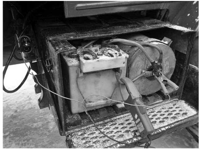
Рис. 1. Размещение модульного и модульного комбинированного источников тока в штатных аккумуляторных отсеках
