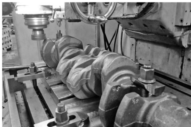
Рис. 9. Фрезеровка вершин противовесов коленчатого вала рядного шестицилиндрового двигателя для устранения избыточного дисбаланса
