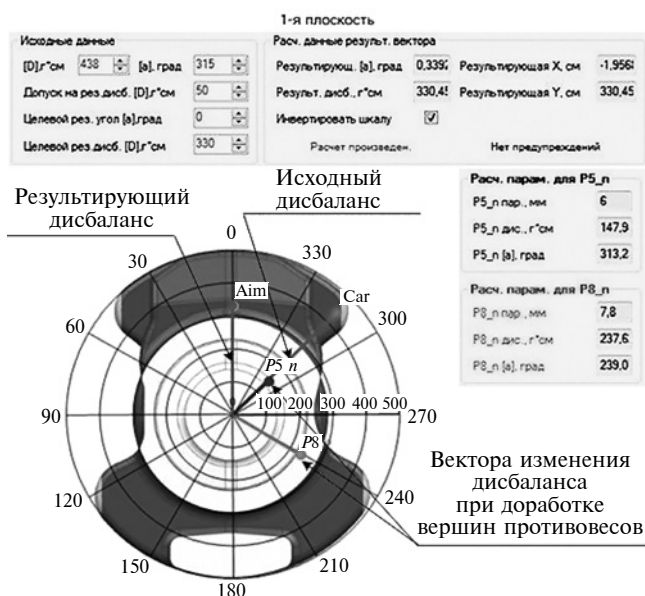
Рис. 8. Визуализация расчёта параметров "перебалансировки" центрованной поковки коленчатого вала в специальной программе ЭВМ
