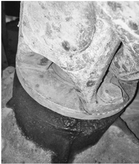
Рис. 3. Течь масла из-под сопряжения вал—сальник ведущего моста
