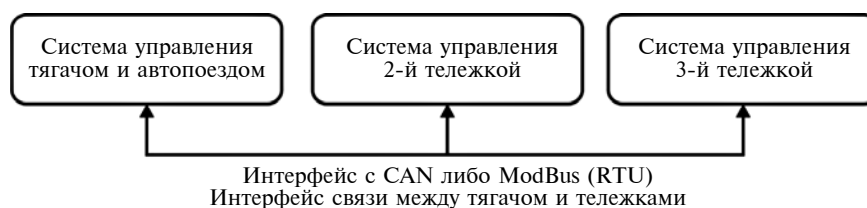
Рис. 12. Общая структура САУД автопоезда
