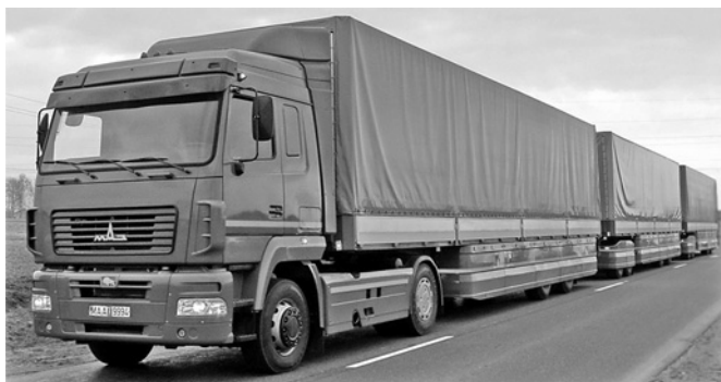
Рис. 15. Макетный образец трёхзвенного автопоезда ОИМ НАН РБ
