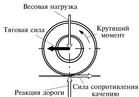
Рис. 2. Схема сил, действующих на ведущее колесо, обнаруженная в интернете
