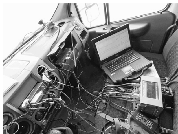
Рис. 6. Установка регистрирующего оборудования в кабине транспортного средства
