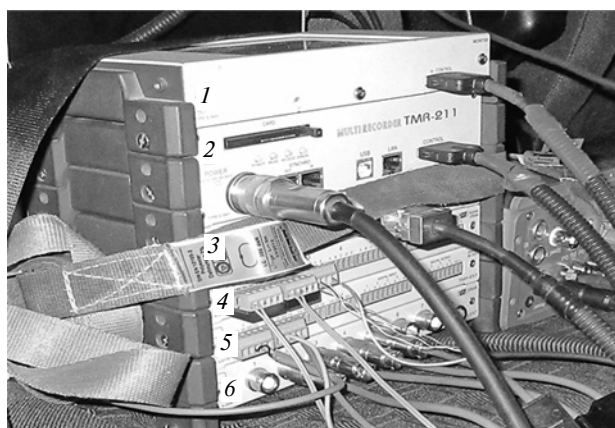
Рис. 5. Динамическая система сбора данных TMR-200: 1 — блок индикации TMR-281 2 — блок управления TMR-211; 3 — блок CAN/Voice/GPS TMR-251; 4 — блок измерения деформации 1G2G4G TMR-222; 5 — блок цифрового ввода-вывода TMR-253; 6 — блок измерения деформации TMR-221
