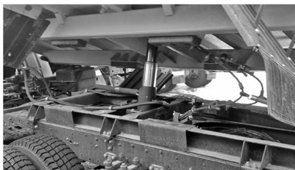
Рис. 1. Общий вид механизма подъёма кузова
