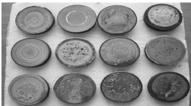
Рис. 3. Поверхность износа толкателей после эксплуатации
