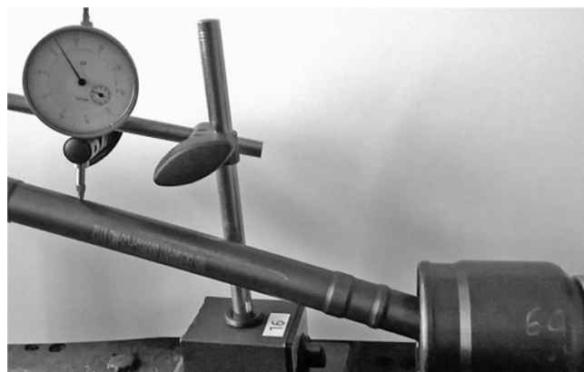
Рис. 1. Установка индикатора часового типа для измерения изменения угла наклона приводного вала в вертикальной плоскости относительно продольной оси корпуса шарнира "Трипод"
