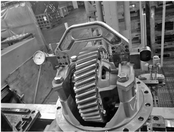
Рис. 8. Технологическая оснастка для регулировки преднатяга подшипников дифференциала редуктора ведущего моста в реальном производстве
