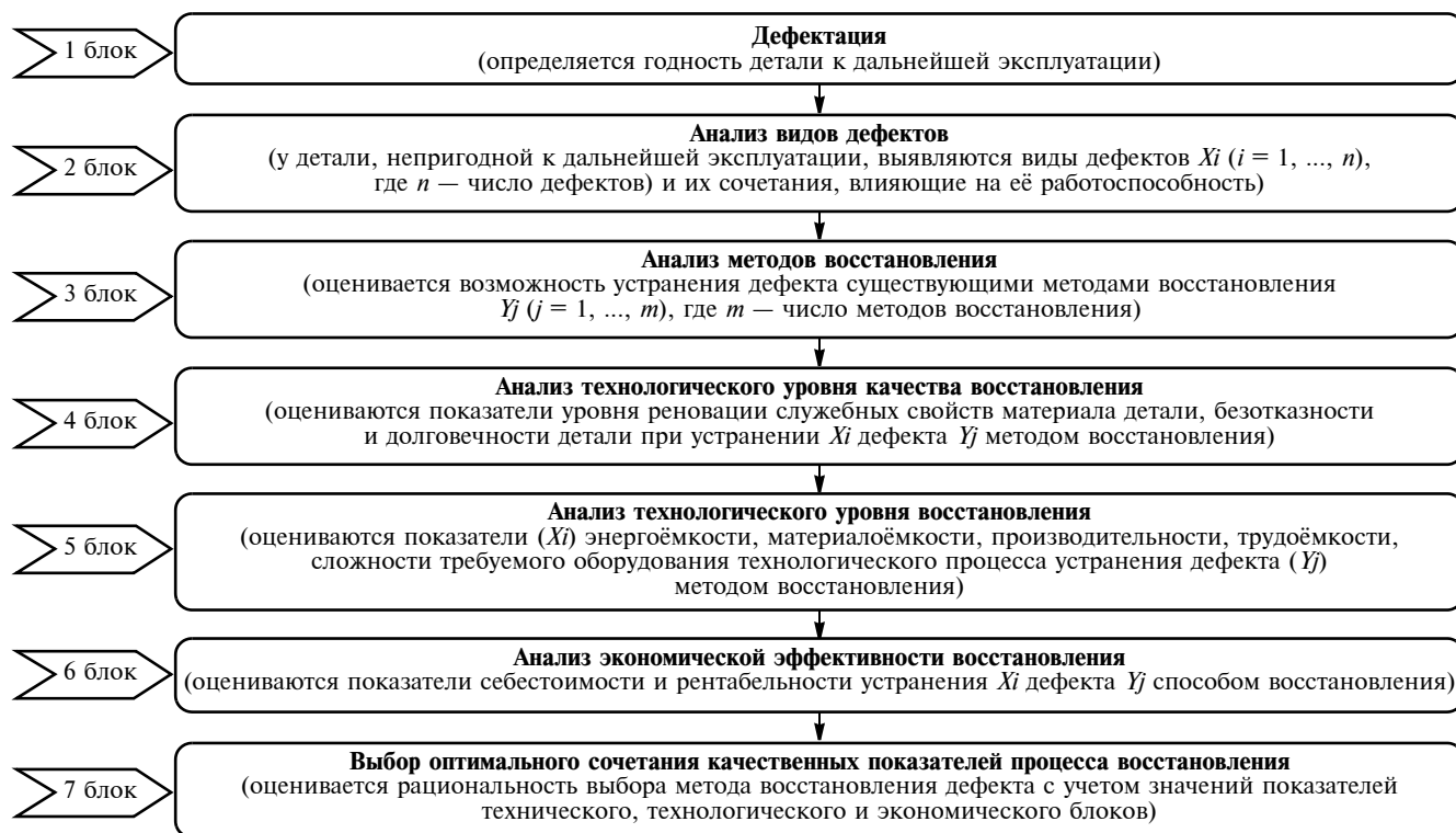
Рис. 2. Алгоритм выбора рационального способа восстановления детали
