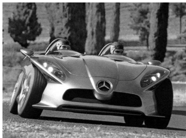
Рис. 1. Автомобиль "Мерседес" с отрицательным развалом колёс
