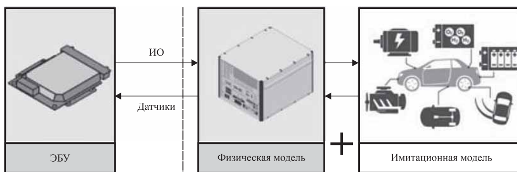
Рис. 11. Физическая модель датчиков и исполнительных механизмов
