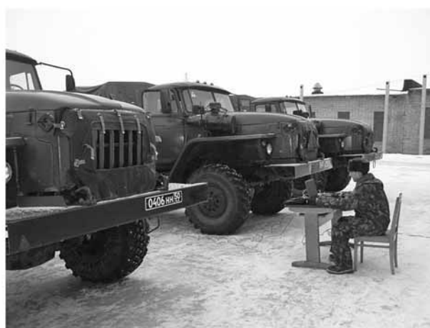
Рис. 2. Проведение натурных испытаний систем электростартерного пуска с КИТ на специальной автомобильной технике
