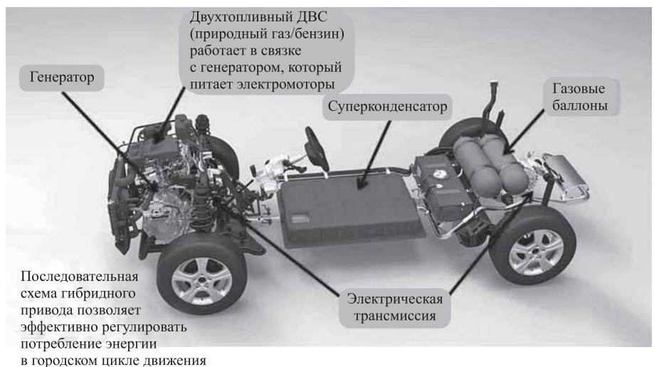
Рис. 3. Последовательный гибридный привод электрифицированного КТС
