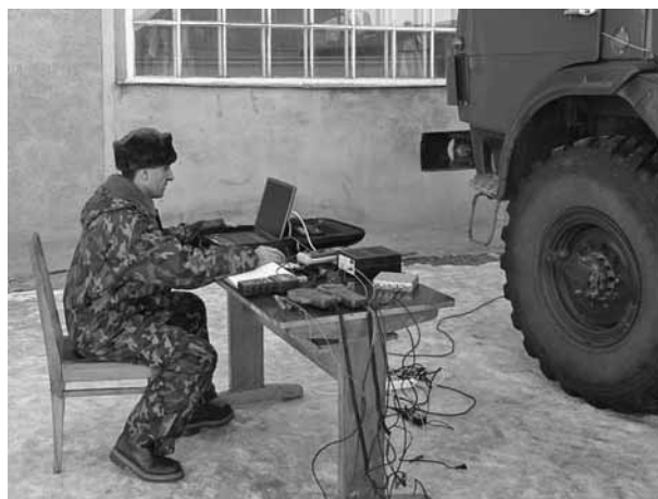
Рис. 2. Проведение натурных испытаний систем электростартерного пуска с КИТ на специальной автомобильной технике
