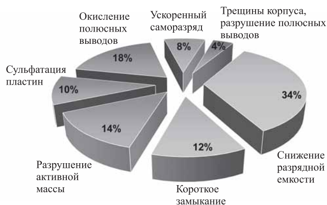
Рис. 1. Распределение неисправностей стартерных аккумуляторных батарей
