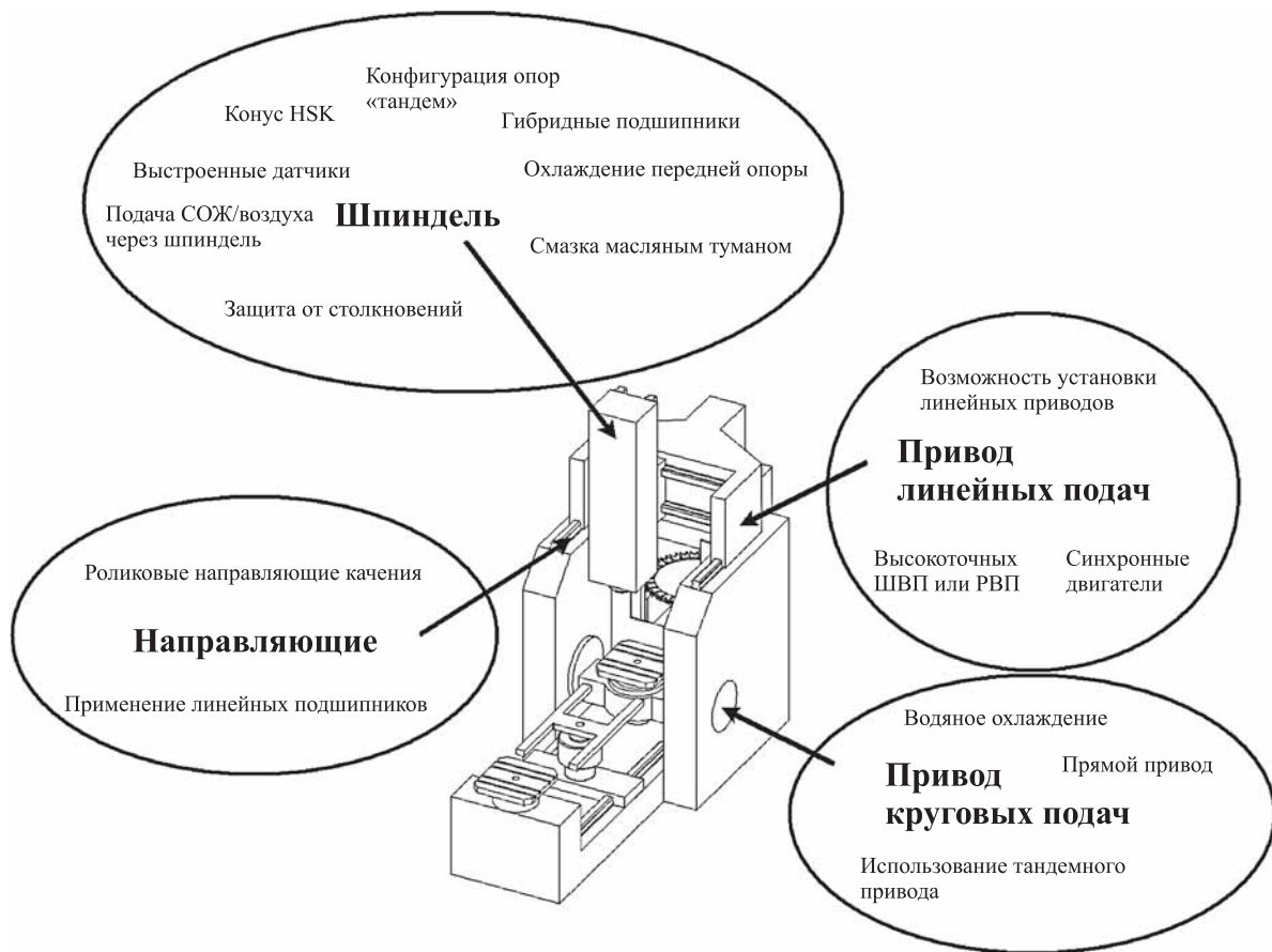
Рис. 6. Узлы и особенности станка для ВСО
