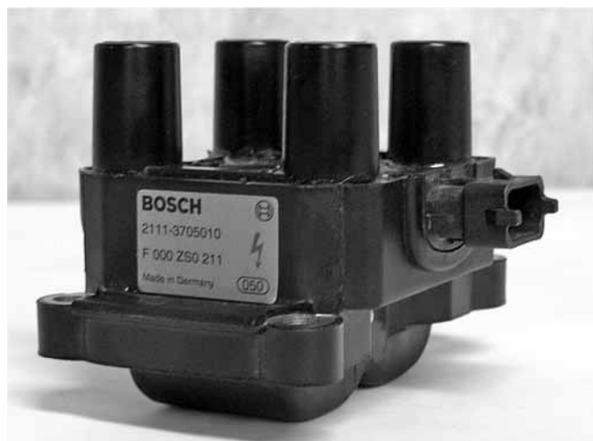
Рис. 2. Модуль зажигания автомобиля ВАЗ-1118
