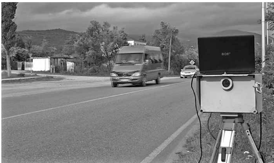
Рис. 2. Фиксация интенсивности транспортного потока с помощью переносных детекторов
