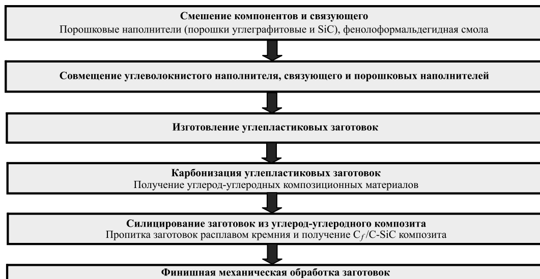
Рис. 3. Схема процесса получения КМК с SiC-матрицей методом силицирования карбонизированного углепластика
