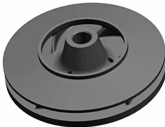
Рис. 2. 3D-модель оптимизированного рабочего колеса
