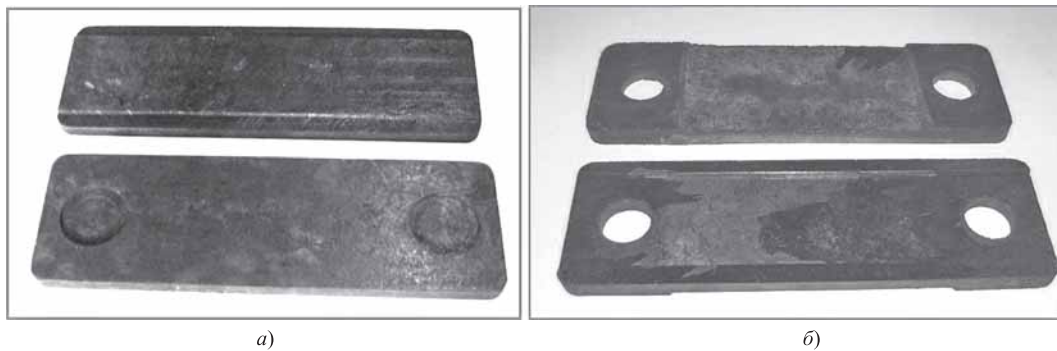
Рис. 5. Общий вид полуфабриката технологической оснастки из КМК нижней (а) и верхней (б) пластин (размер пластин 279S87S14 мм)
