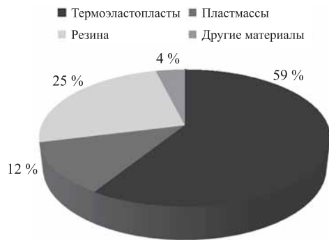
Рис. 2. Материалы, используемые при изготовлении подошвы современной обуви
