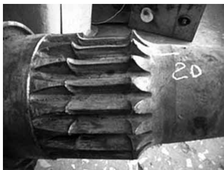
Рис. 1. Износ зубьев шестерни поворота колонны гидроманипулятора
