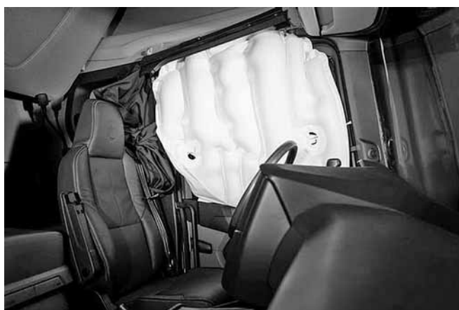
Рис. 1. Испытания на эффективность надувных подушек системы пассивной безопасности
