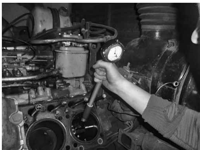
Рис. 5. Процесс измерения гильз 7-го и 8-го цилиндров ДВС КАМАЗ-740
