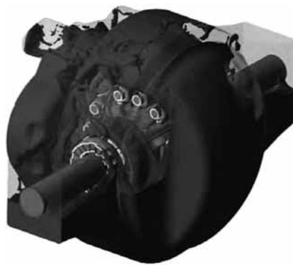
Рис. 12. Распределение масла в расчетной области (режим 1)
