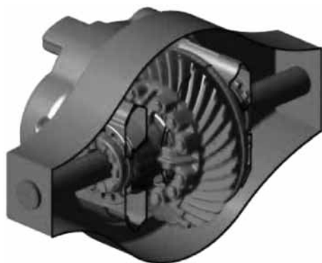
Рис. 2. Твердотельная модель фрагмента картера моста в сборе
