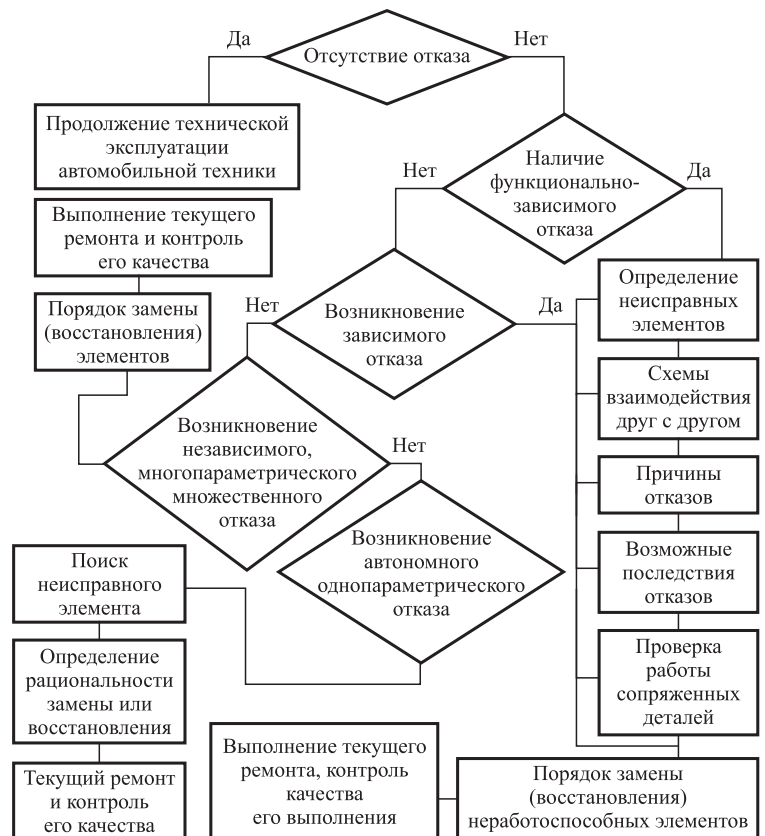
Рис. 4. Блок-схема алгоритма процесса распознавания вида отказа
