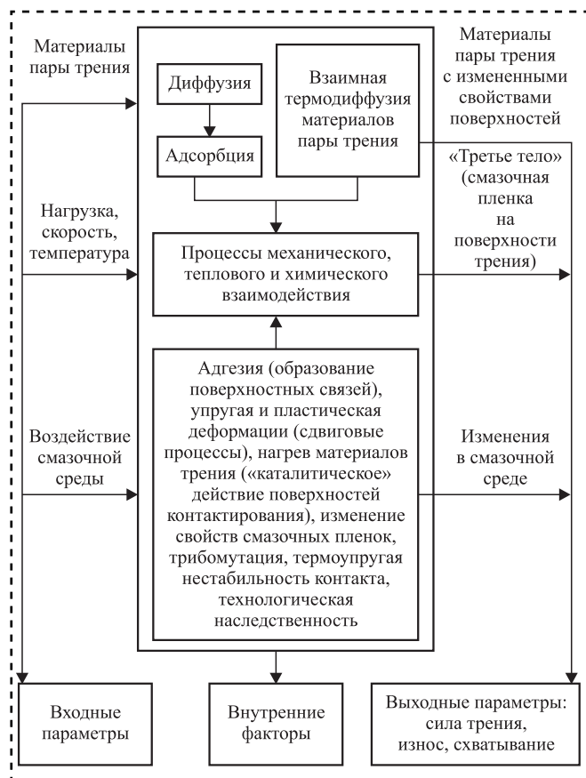
Рис. 1. Процессы в зоне контакта трибологических систем при смешанном смазывании [1–12]
