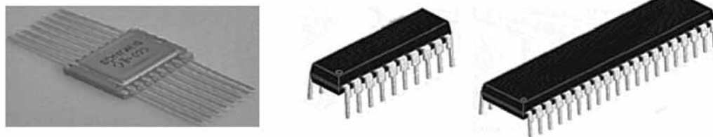
Рис. 1. Корпусные ИМС с планарными и штырьковыми выводами
