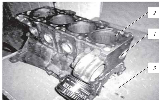
Рис. 1. Блок цилиндров с гильзами на ремонтном столе: 1 — блок цилиндров; 2 — гильза; 3 — ремонтный стол
