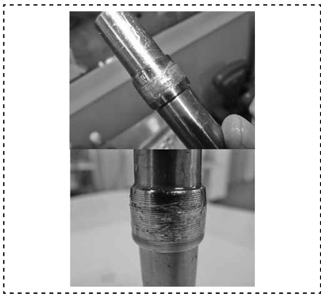
Рис. 3. Микростружка, образующаяся в результате дорнования отверстий инструментом с параметрами РМР \Gamma_k = 20 мкм, \Pi_k = 0,5 мм и объемной долей присадки C = 20 %
