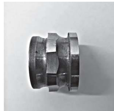
Рис. 4. Конструкция (а) и внешний вид (б) режущего элемента в виде двузубой секции переменной схемы
