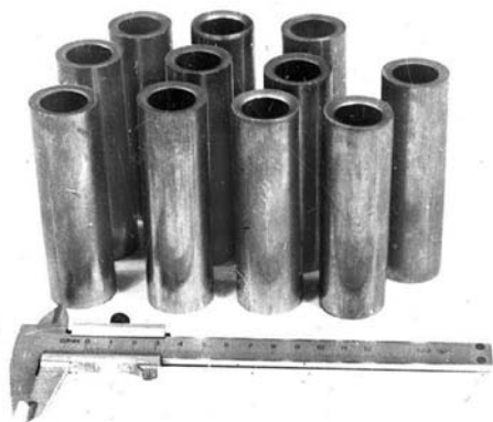
Рис. 1. Стаканы, изготовленные холодным выдавливанием из спеченных цилиндрических порошковых заготовок
