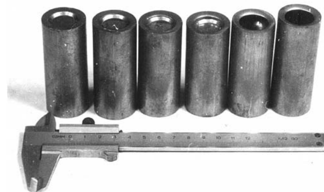
Рис. 7. Поэтапное формоизменение спеченной порошковой заготовки при выдавливании из нее стакана при активном действии напряжений контактного трения
