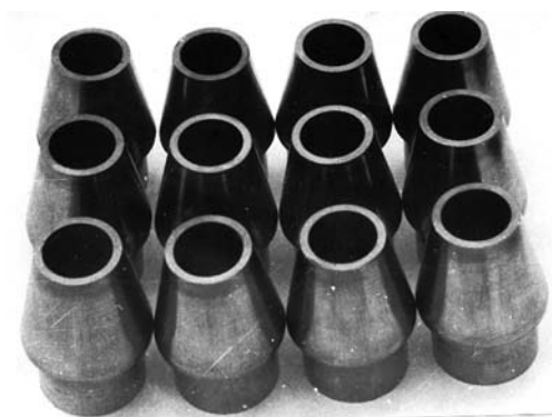
Рис. 2. Втулки со ступенчатой внешней поверхностью из порошка, до их спекания
