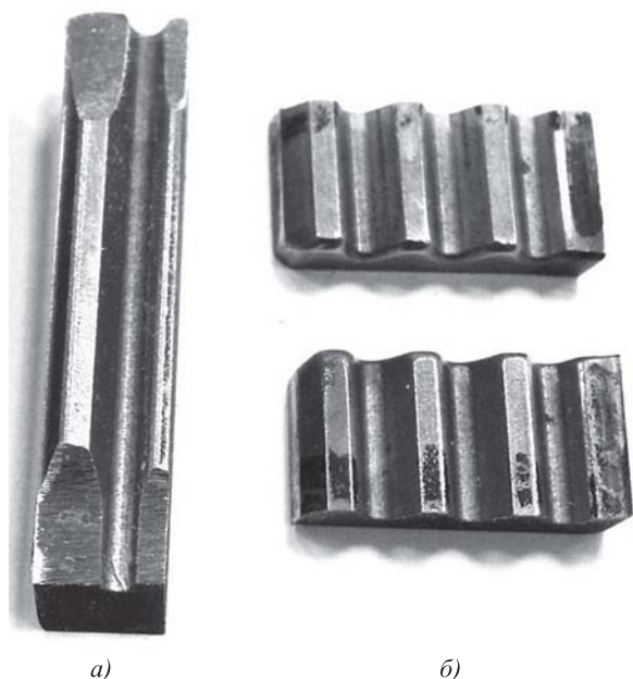
Рис. 6. Образцы для измерения остаточных напряжений: а — для осевой составляющей; б — для тангенциальной
