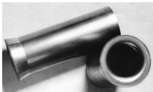
Рис. 4. Стаканы из порошка, до их спекания
