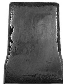
Рис. 12. Заготовка, сформованная из порошка ПЖВ2.160.28 и фрезерованная до ее спекания
