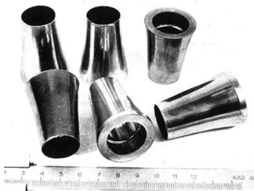
Рис. 3. Втулки с тонкой стенкой из порошка, до их спекания
