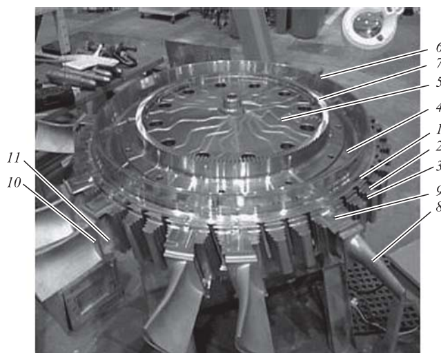
Рис. 1. Диск с пазами "елочного" типа для установки рабочих лопаток:
