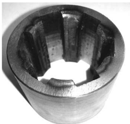
Рис. 3. Шлицевая втулка после ЭМЗ (сталь 40Х)
