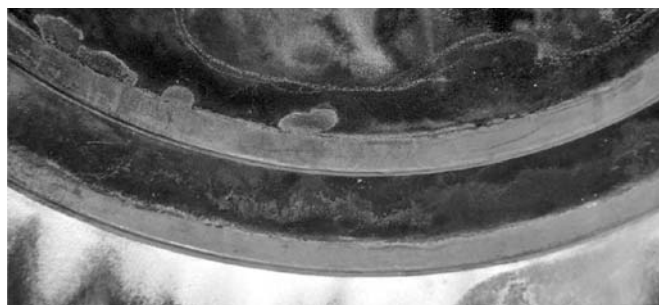
Рис. 5. Местное разрушение покрытия после огневых испытаний камеры сгорания
