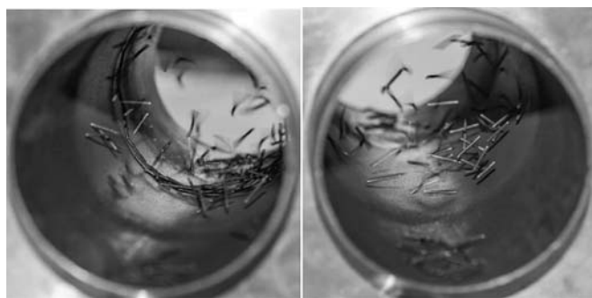
Рис. 3. Характер движения ферромагнитных частиц во вращающемся электромагнитном поле
