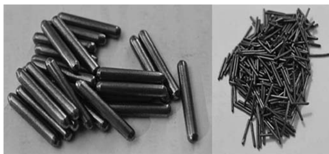
Рис. 2. Обрабатываемая среда — стальные цилиндры: а — ШХ15 (ГОСТ 801—78); б — 50ХФА (ГОСТ 14959—2016)
