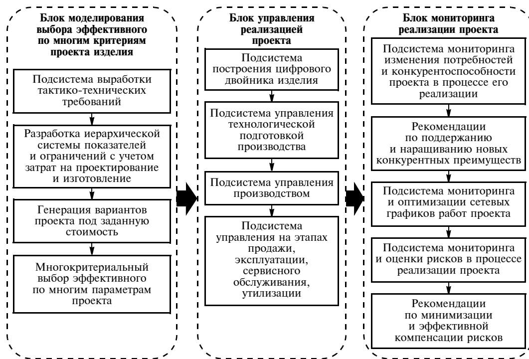
Рис. 1. Функциональная блок-схема системы поддержки принятия решений
