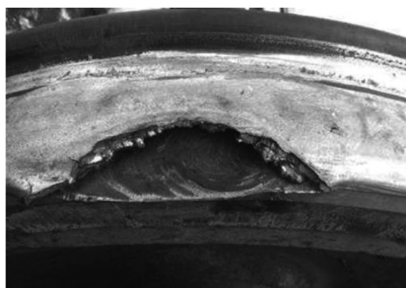
Рис. 1. Типичное повреждение вагонного колеса с отколом обода от подповерхностной усталостной трещины, зародившейся на металлургическом дефекте [11]
