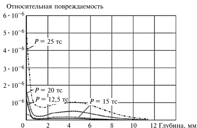
Рис. 10. Относительная повреждаемость в контактной зоне обода колеса
