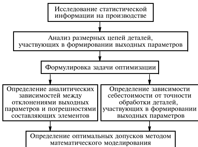
Рис. 4. Алгоритм оптимизации допусков при проектировании изделий
