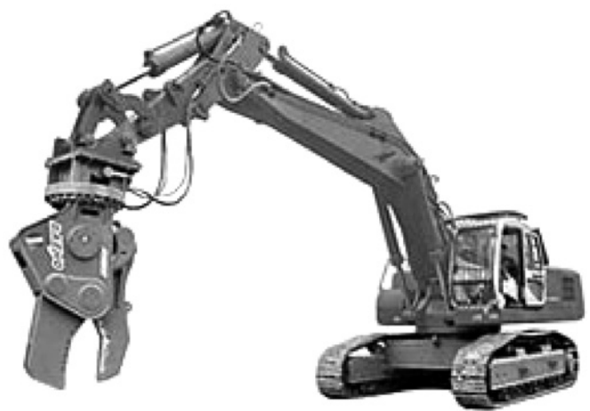
Рис. 2. Экскаватор с гидроножницами
