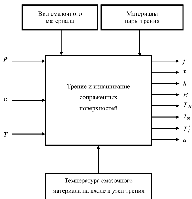
Рис. 4. Схема работы пары трения
