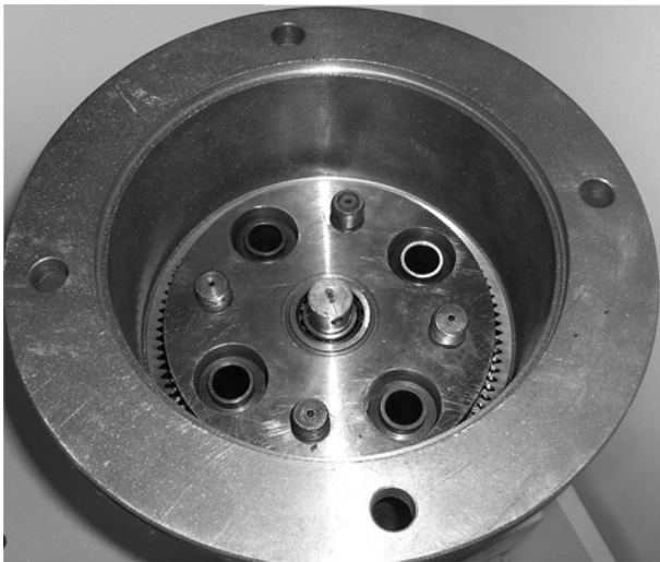
Рис. 5. Планетарная передача привода транспортера, отличающаяся малой разницей чисел зубьев колес и наличием промежуточных роликов
