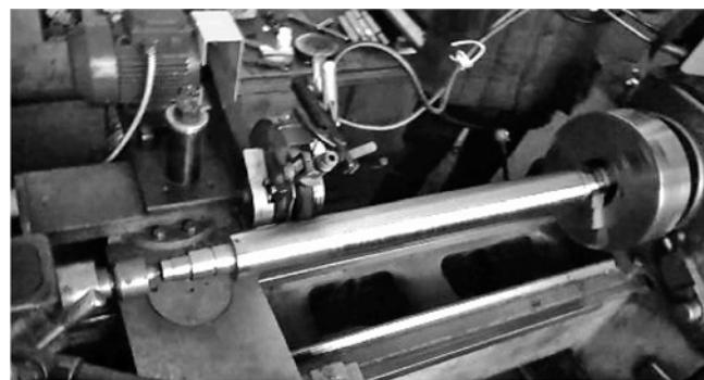
Рис. 3. Формирование покрытия "хром + УДАГ" методом ЭФП на рабочей поверхности штока гидроцилиндра
