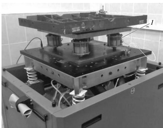
Рис. 3. Вибростенд Star28 для проведения испытаний четырех МР-гидропор ОГМ-95 (поз. 1) под нагрузкой F = 0,5 кН при действии ШСВ
