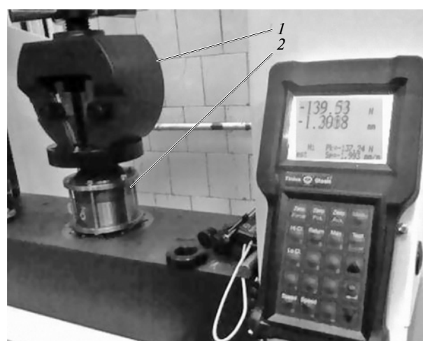
Рис. 1. Испытания на нагружение МР-гидропоры ОГМ-95 (поз. 1) на универсальной испытательной машине фирмы Tinius Olsen Ltd модель H100KU (поз. 2)
