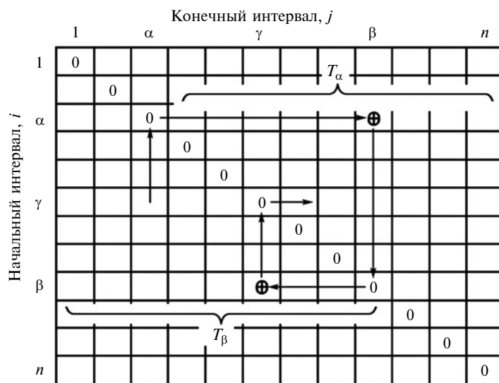
Рис. 2. Схема, поясняющая алгоритм моделирования случайной последовательности по марковской матрице повторений (синтез)
