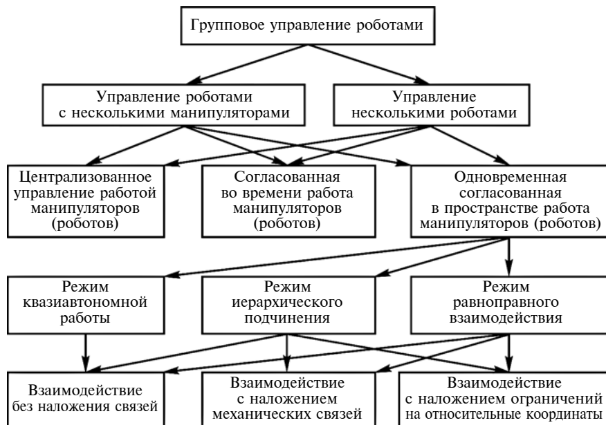
Рис. 1. Структурная схема группового управления манипуляторами и роботами
