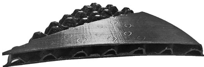
Рис. 8. Модель сферической оболочки трехслойной конструкции с дискретным наполнителем
