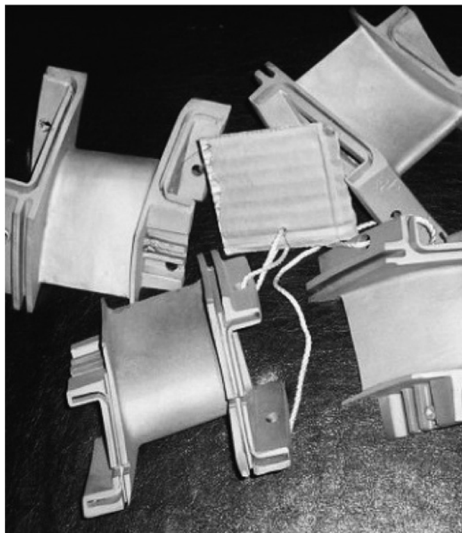
Рис. 2. Лопатки двигателя ТВ3-117 после гидроабразивной очистки
