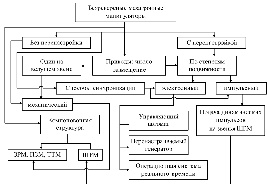
Рис. 6. Классификация компоновочных структур безреверсных ММ с автоматическим управлением механизмами:
