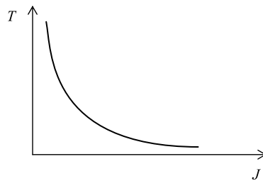
Зависимость трудоемкости T обработки заготовки от качества J точности координирующих размеров
