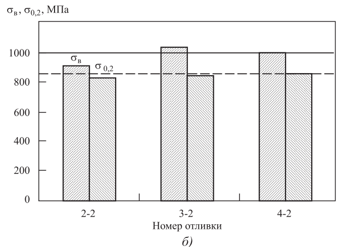
Рис. 11. Предел прочности \sigma_B и условный предел текучести \sigma_{0,2} образцов, изготовленных из отливок, ( a ) и образцов-свидетелей ( б ):
