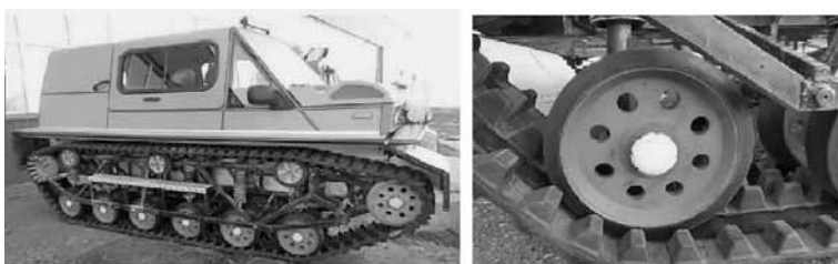
Рис. 5. Использование материала "Римаид" в конструкции ходовой части легких гусеничных машин
