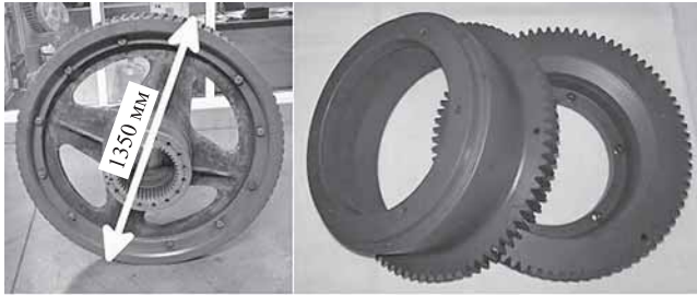
Рис. 4. Шестерни из материала "Римаид"
