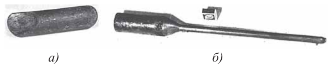
Рис. 6. Пруток после СД и ВТГП:
