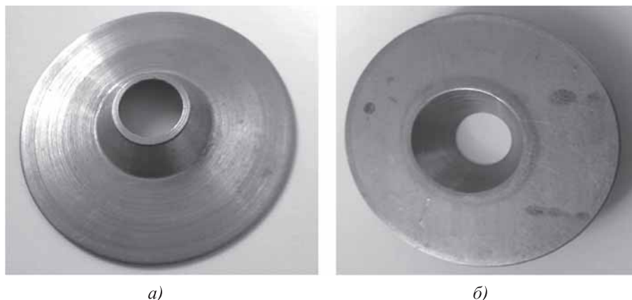
Рис. 6. Заготовка тарелки втулки после деформирования с нагревом в электродах машины контактной точечной сварки с наружной (а) и внутренней (б) сторон
