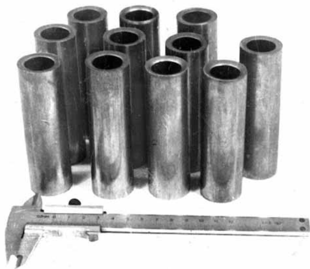
Рис. 1. Стаканы, изготовленные ХОШ из порошковых заготовок
