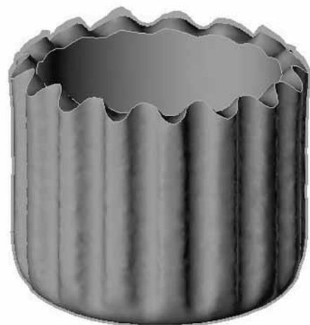
Рис. 5. Форма полуфабриката после вытяжки в матрице с синусоидальной формой выступов рабочего пояска матрицы
