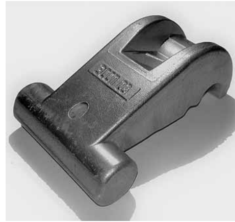
Рис. 8. Отливка "корпус" (масса 0,381 кг, толщина стенки 4,5...23 мм, максимальный габаритный размер 120 мм) из Al-сплава электротехнического назначения
