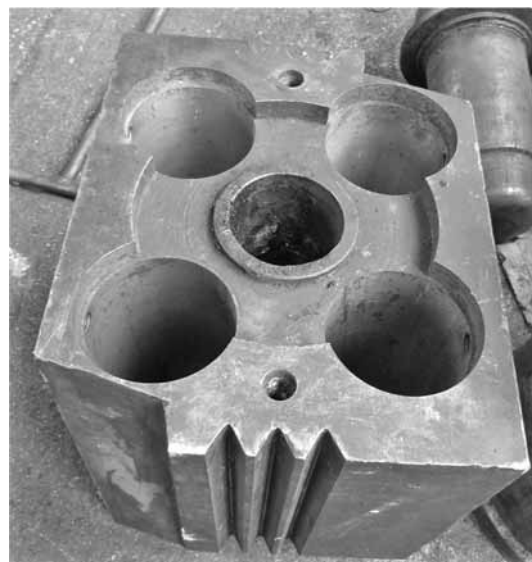
Рис. 1. Корпус модернизированной бабы штамповочного молота мод. М2140
