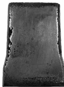
Рис. 5. Заготовка, сформованная из порошка ПЖВ2.160.28, фрезерованная, шлифованная и полированная до ее спекания
