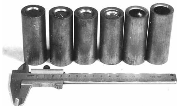
Рис. 3. Поэтапное формоизменение спеченной порошковой заготовки при ее выдавливании по схеме, приведенной на рис. 2
