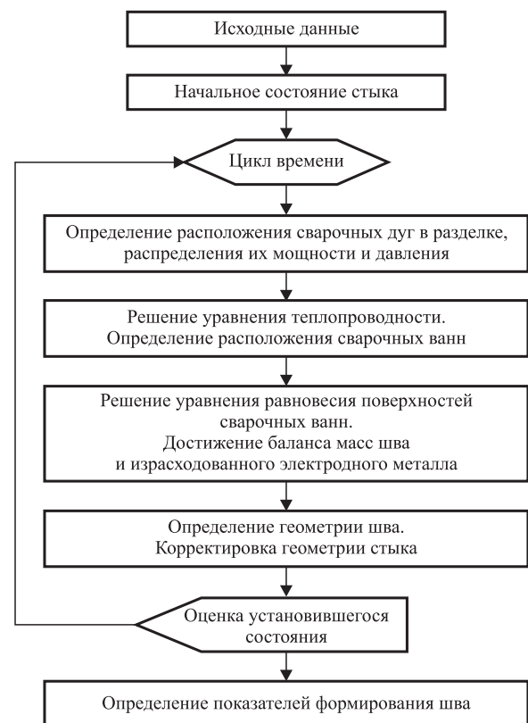
Рис. 5. Алгоритм виртуального изучения технологии двухдуговой сварки вертикальных стыков
