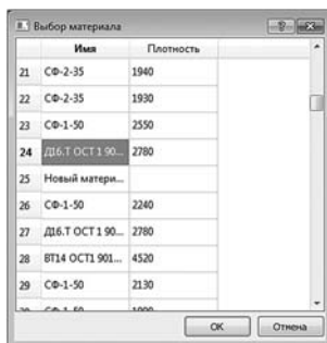
Рис. 2. Ввод материала из базы данных. Диалоговое окно открыто после выполнения команды меню «Правка/База данных/Назначить материал элементу»
